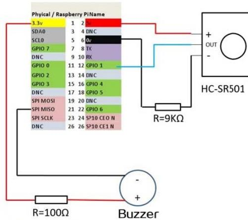
Fig. 8. Alarm circuit
