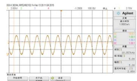
Figure 17 : 10KHz sine wave
